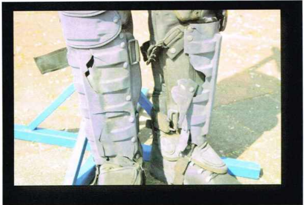
Figuur 61 De impact van een 3 inch shell op scheenbeschermers.
