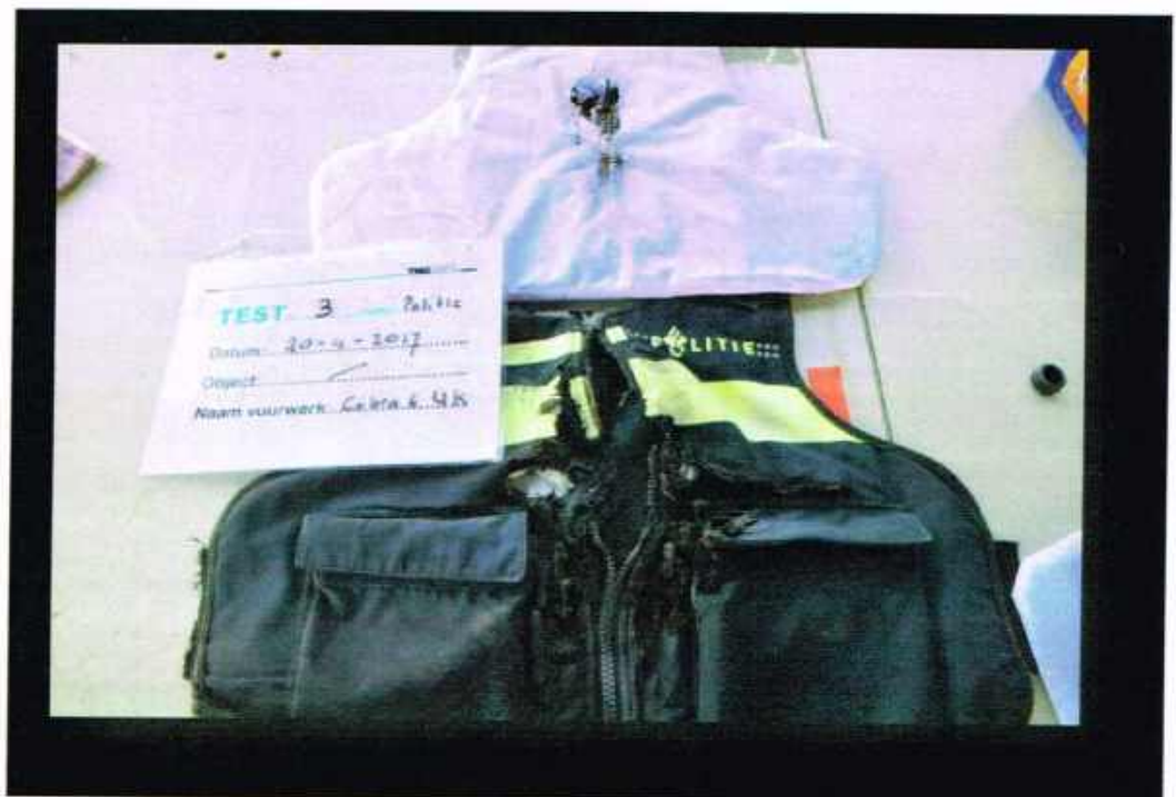
Figuur 47 Een beschadigd vest; de gevolgen bij direct contact van een Super Cobra 6 (Engelse tekst).
