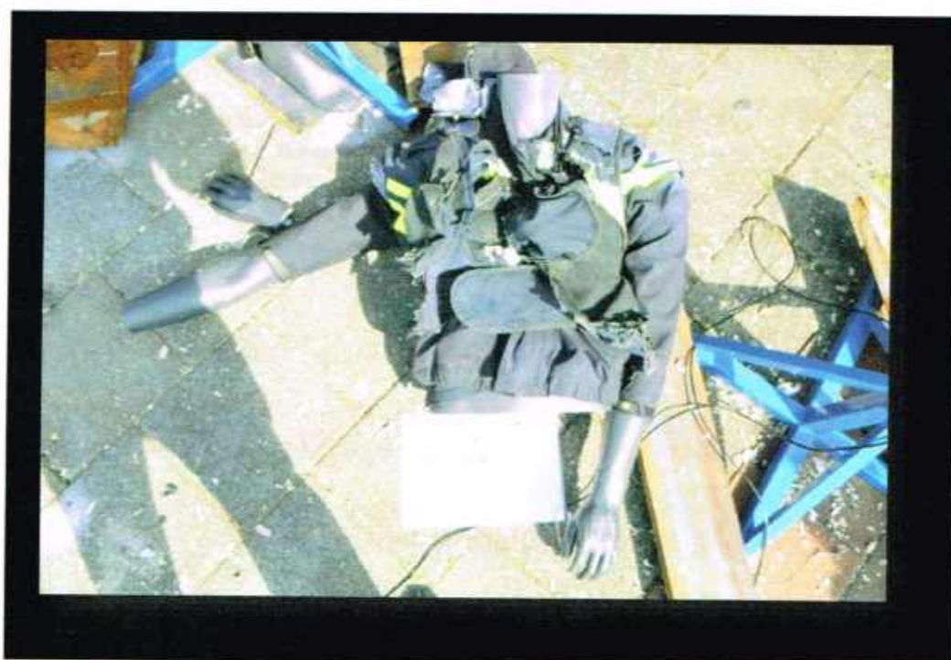
Figuur 50 De paspop is volledig beschadigd door impact van een Cobra 8 bij direct contact.
