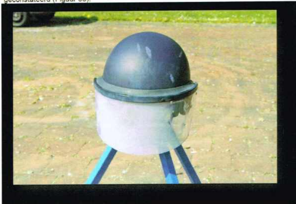
Figuur 58 Impact van een Thunderking op 0,25 meter. Alleen de gelaatscherm is wit uitgeslagen.
