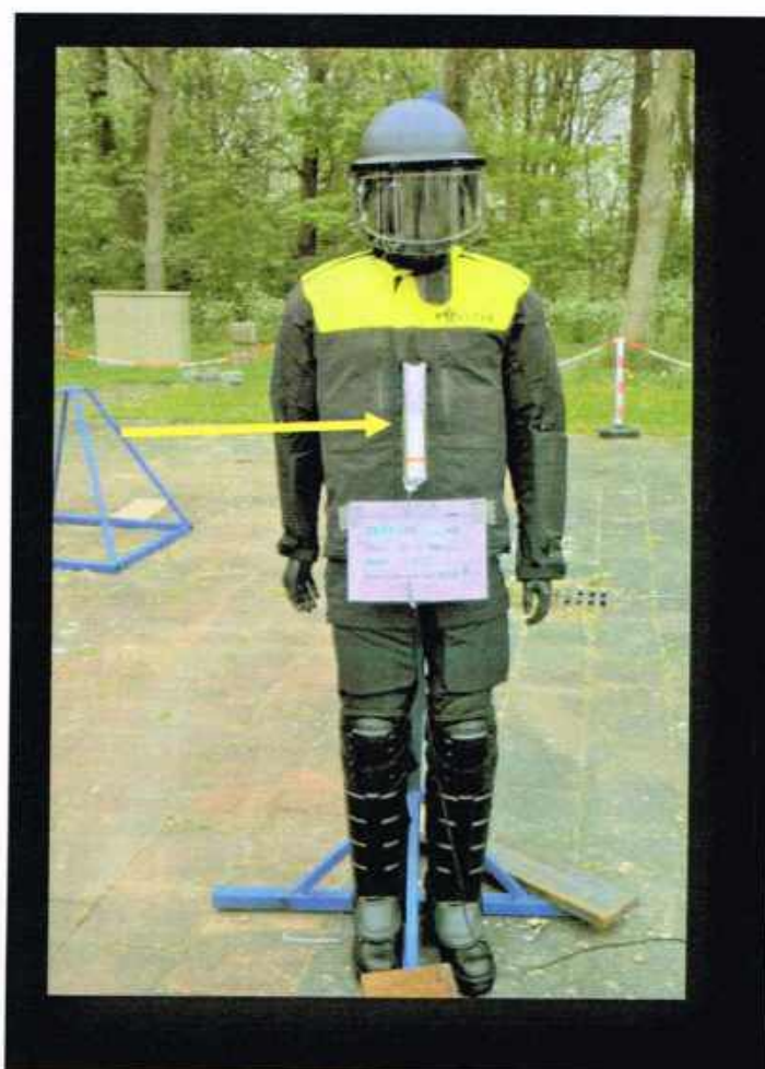
Figuur 29 Een volledige kledinguitrusting van de ME, een Cobra 8 (gele pijl) bij direct contact.
