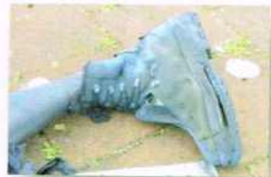
Figuur 56 De impact van een Cobra 8 tussen een paar schoenen.
