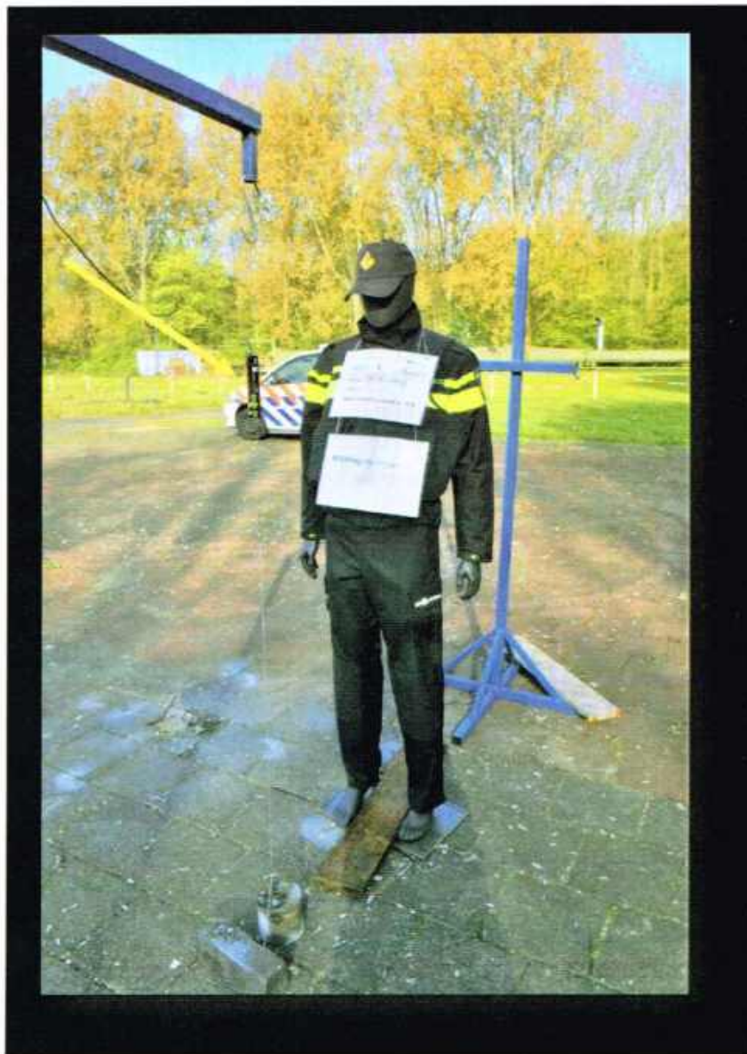
Figuur 16 Een volledige kledinguitrusting van de Politie. De impact van een Super Cobra 6 (Engelse tekst) op een afstand van 0,5 meter.
