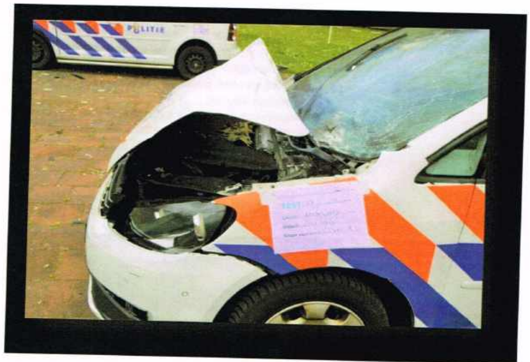
Figuur 66 De impact van een Cobra 8 op de voorruit (plus veiligheidsfolie) van een Volkswagen Touran.
