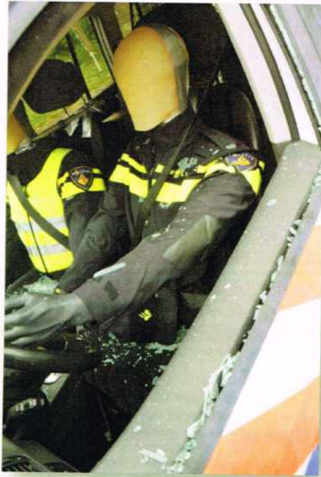
Figuur 68 De impact van een 3 inch shell op de zijruit van een Volkswagen Touran.
