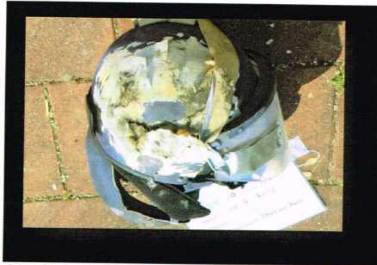
Figuur 59 Impact van een Thunderking bij direct contact. De helm is volledig vernietigd. De zijkant van de helm is gescheurd.
