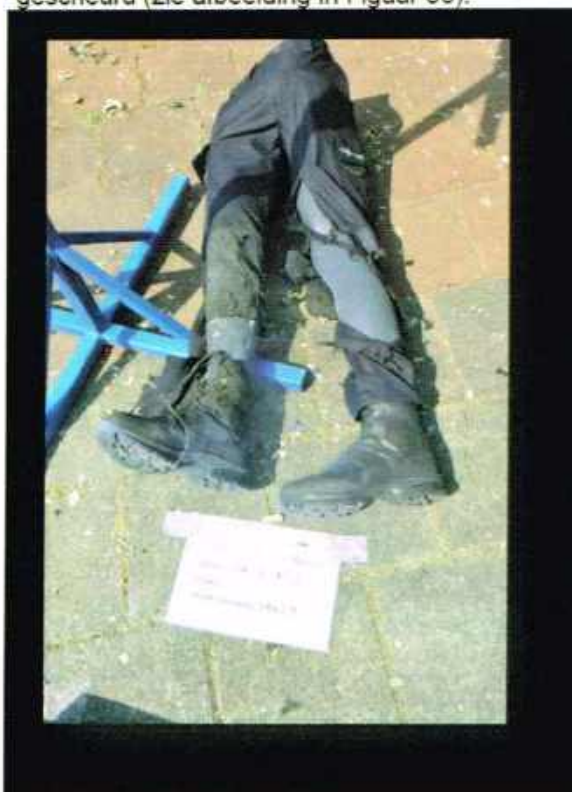
Figuur 54 De impact van een 3 inch shell op de schoenen en Politiebroek.
