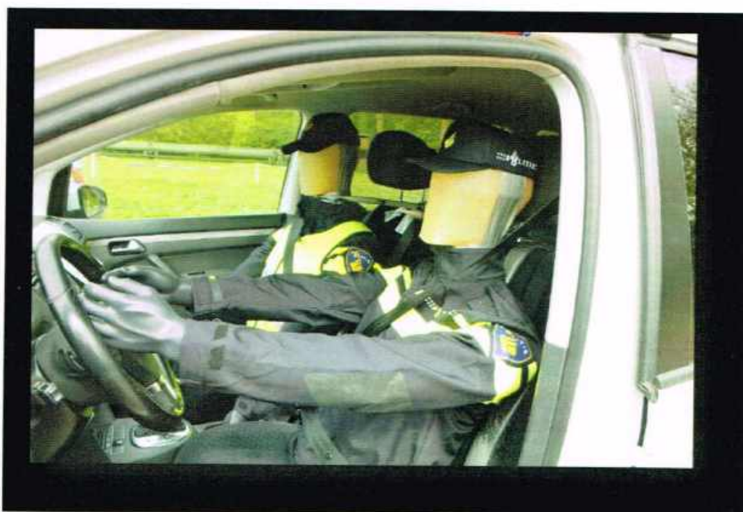
Figuur 26 Het dienstvoertuig van de Politie, een Cobra 8 tussen voorruit en motorklep. Paspoppen voorzien van zeefhoofden. Inclusief drukmetingen in voertuig.
