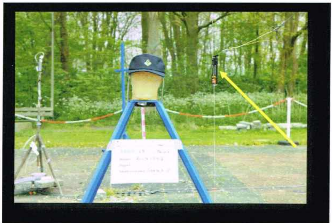
Figuur 22 Zeephoofd met cap en veiligheidsbril, impact van een Super Cobra 6 (Italiaanse tekst) (gele pijl) op een afstand van 0,25 meter.
