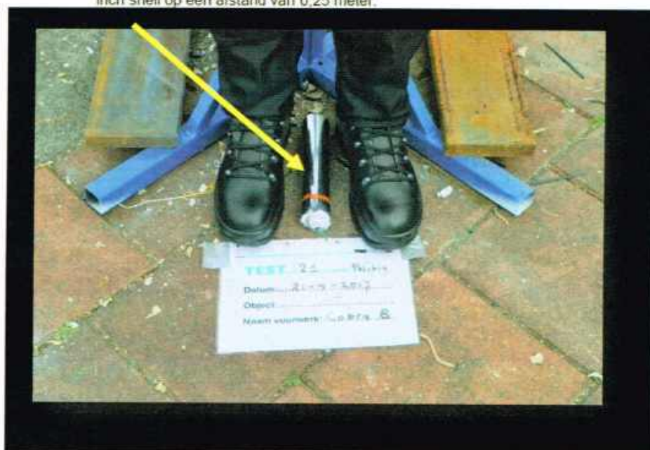
Figuur 24 Politiebroek met schoenen, impact van een Cobra 8 (gele pijl).
