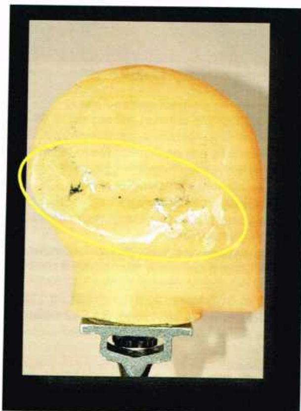
Figuur 60 Impact van een Thunderking op het zeep hoofd bij direct contact op een ME helm. Een behoorlijke indeuking is zichtbaar aan de zijkant van het zeep hoofd (gele cirkel).
