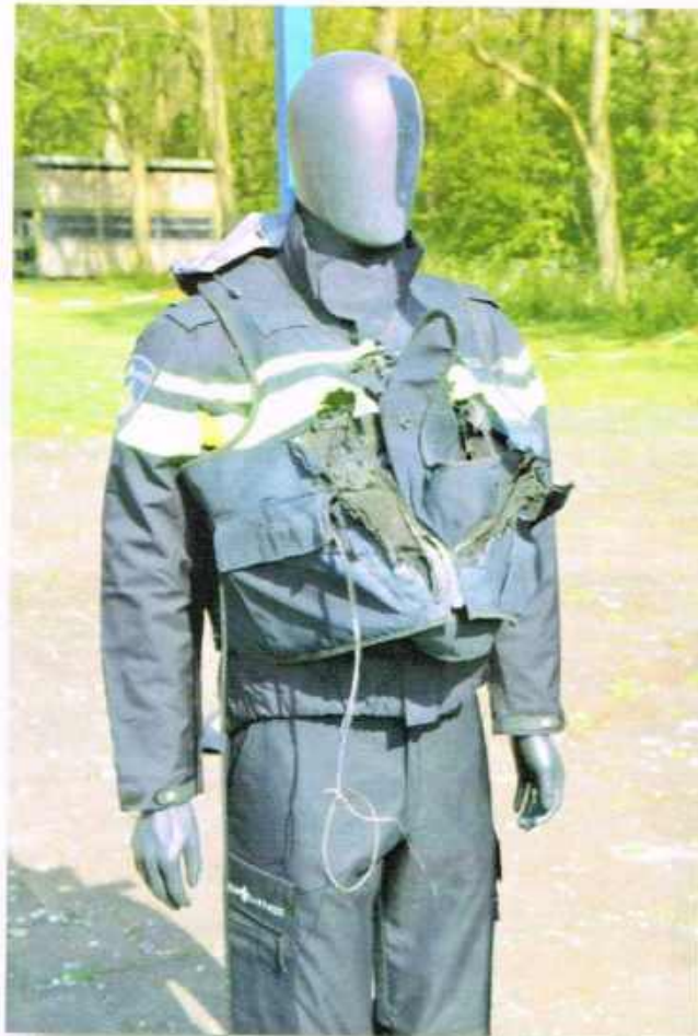
Figuur 48 Zichtbaar het beschadigde vest door de impact van een Super Cobra 6 (Italiaanse tekst) bij direct contact.
