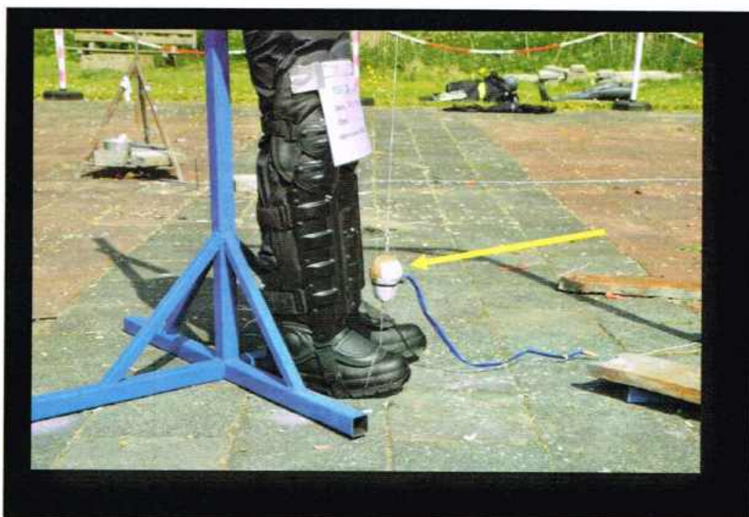
Figuur 20 Scheenbeschermers in gebruik bij de ME. De impact van een 3 inch shell (gele pijl).
