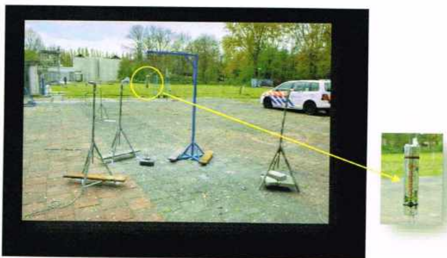
Figuur 15 De test set-up; zichtbaar de verschillende aerodynamisch gevormde drukopnemers.
