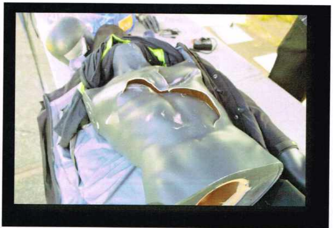
Figuur 51 Bij de paspop is de borstkas ingedrukt door de impact van een Cobra 8 bij direct contact.
