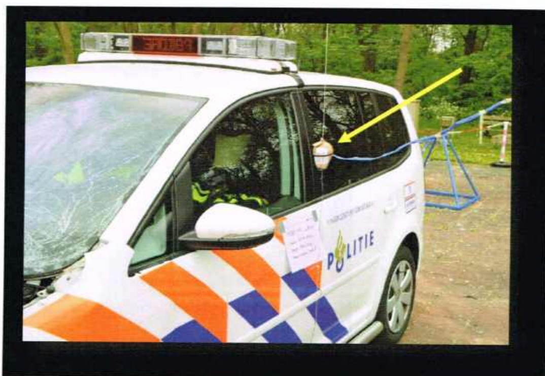
Figuur 27 Het dienstvoertuig van de Politie, een 3 inch shell (gele pijl) naast het voertuig op een afstand van 0,25 meter van de linker zijruit.
