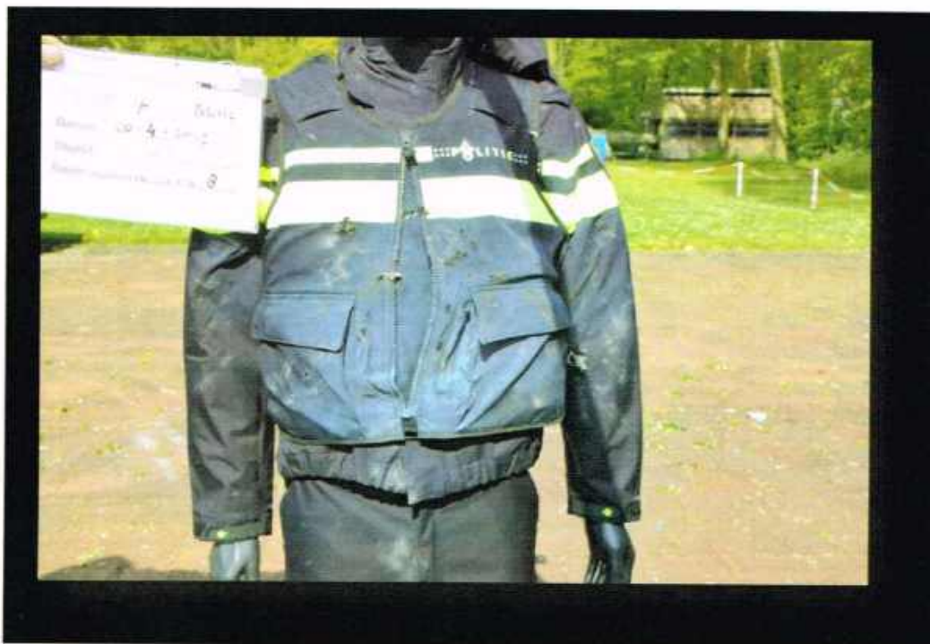
Figuur 49 Een beschadigd vest, de gevolgen een Cobra 8 op 0,25 meter.
