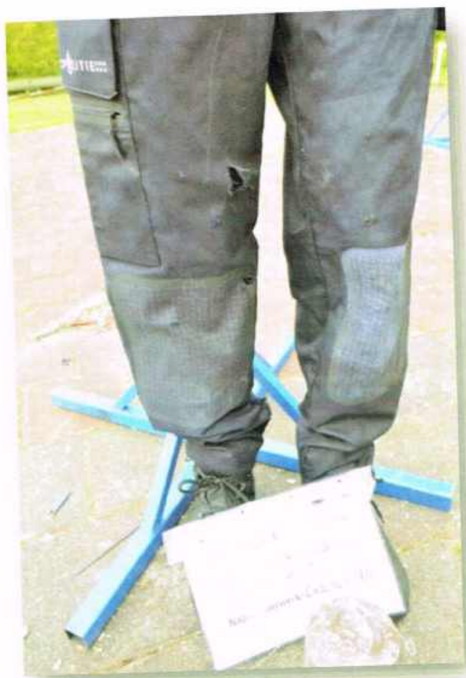
Figuur 53 De impact van een Super Cobra 6 (Duitse tekst) op een Politiebroek.
