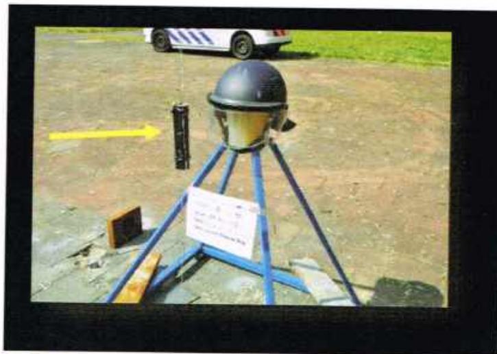
Figuur 18 Een helm in gebruik bij de ME. De impact van een Thunderking (gele pijl) op een afstand van 0,25 meter.
