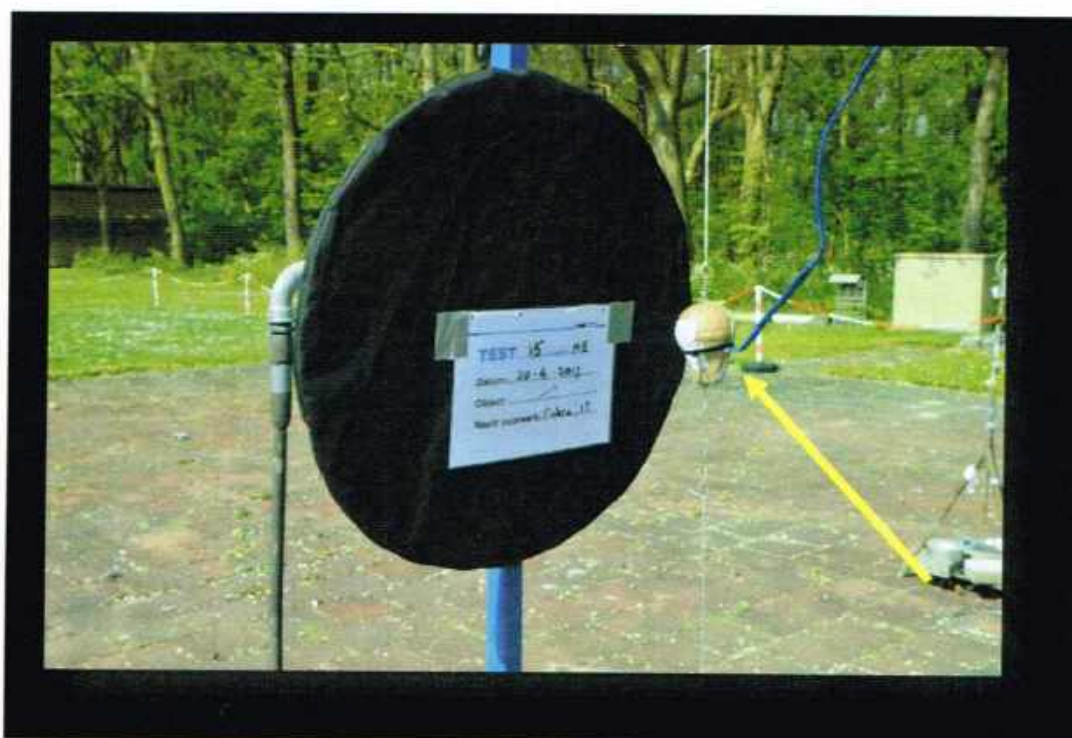
Figuur 21 Een schild in gebruik bij de ME. De impact van een 3 inch shell (gele pijl) op een afstand van 0,25 meter.
