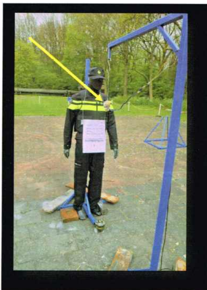
Figuur 23 De kledinguitrusting van de Politie bestaande plus veiligheidsbril, impact van een 3 inch shell op een afstand van 0,25 meter.
