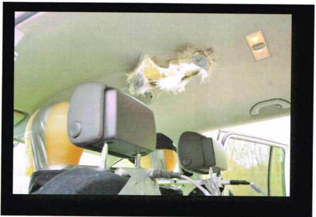
Figuur 69 Zichtbaar een gat in het dak van de Volkswagen Touran veroorzaakt door een Super Cobra 6 (Duitse tekst).
