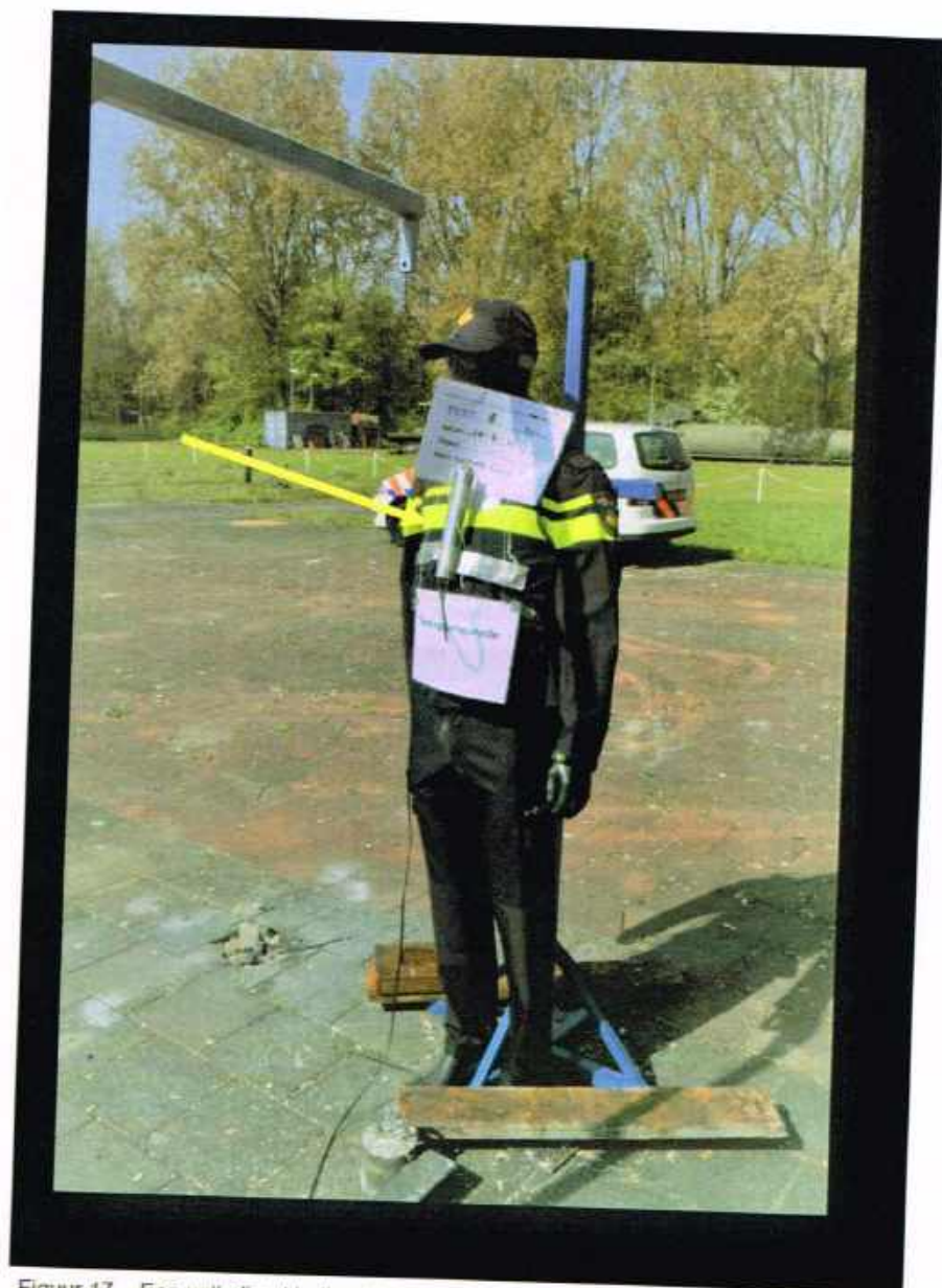
Figuur 17 Een volledige kledinguitrusting van de Politie. De impact van een Cobra 8 (gele pijl).
