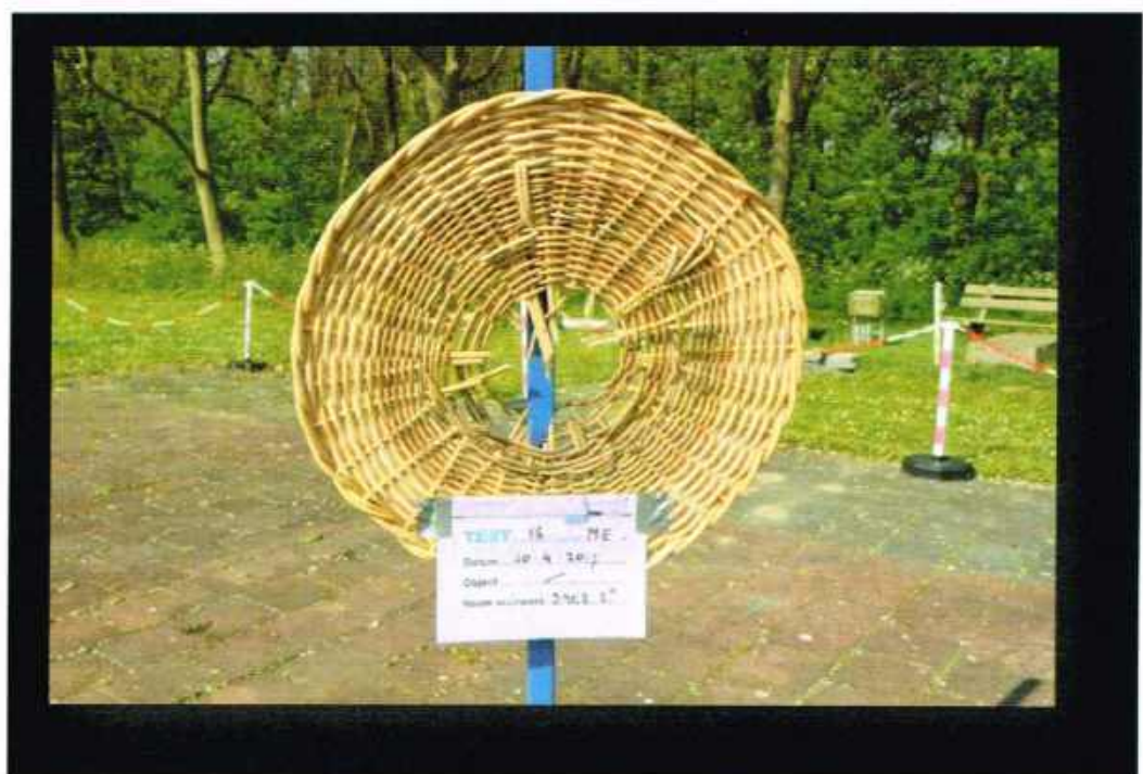
Figuur 63 De impact van een 3 inch shell bij direct op ME schild.
