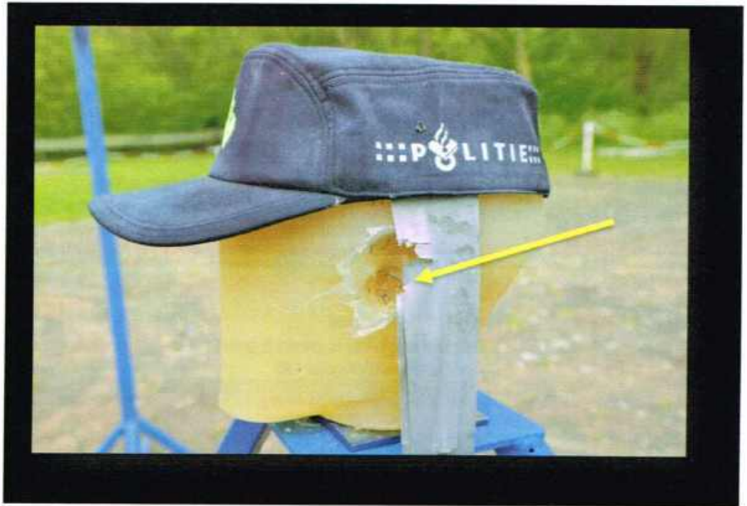
Figuur 57 Een indeuking (gele pijl) van een zeephoofd door een Super Cobra 6 (Italiaanse tekst).
