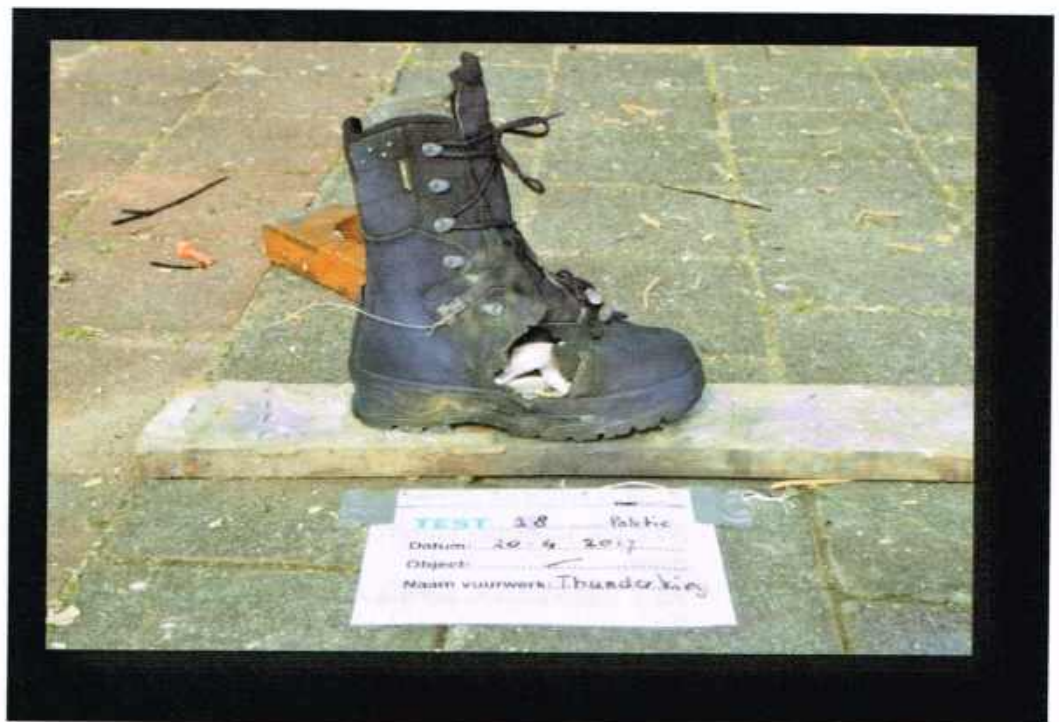
Figuur 55 De impact van een Thunderking op de zijkant van een schoen.
